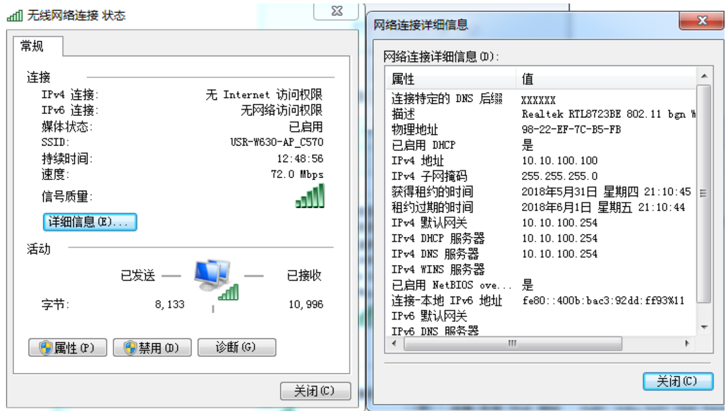
图 3 无线网络连接示意
